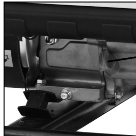
Fig. 6 – tapa del nivel de aceite (varilla)
